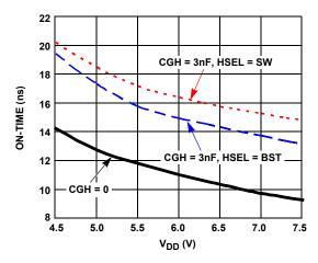
FIGURE 6. MINIMUM GH ON-TIME,  $t_{GH,ON}$  ( $T_A = +25$ °C)
