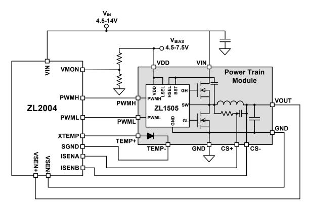
FIGURE 2. POWER TRAIN MODULE USING ZL2004 PWM CONTROLLER
