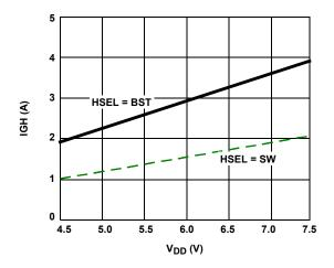
FIGURE 20. HIGH-SIDE DRIVER PULL-DOWN CURRENT (V<sub>GH</sub> - V<sub>SW</sub> = 2.5V, T<sub>A</sub> = +25 °C)
