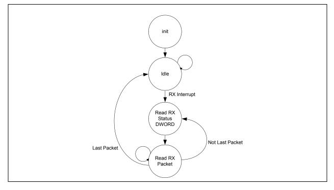
FIGURE 11-15: HOST RECEIVE ROUTINE USING INTERRUPTS
