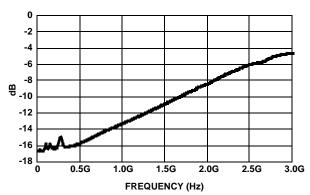
FIGURE 11. |S22| vs FREQUENCY
