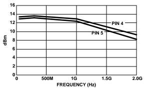
FIGURE 15. 1dB COMPRESSION POINT vs FREQUENCY
