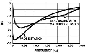
FIGURE 32. |S11| vs FREQUENCY
