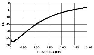
FIGURE 3. |S11| vs FREQUENCY
