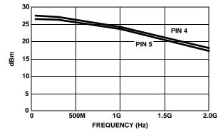
FIGURE 18. OIP3 vs FREQUENCY
