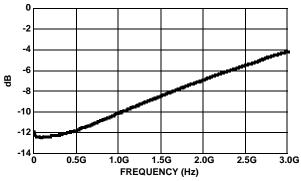
FIGURE 9. |S11| vs FREQUENCY
