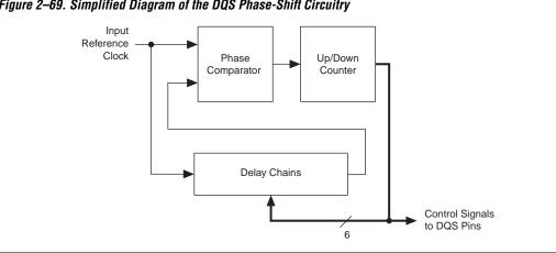
Figure 2–69. Simplified Diagram of the DQS Phase-Shift Circuitry
