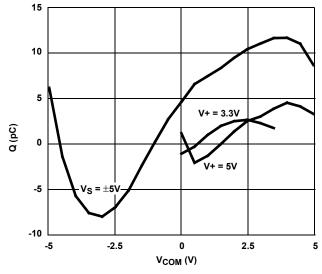
FIGURE 12. CHARGE INJECTION vs SWITCH VOLTAGE
