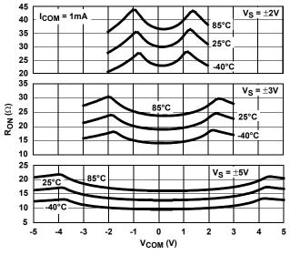
FIGURE 11. ON RESISTANCE vs SWITCH VOLTAGE
