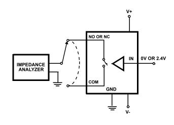
FIGURE 7. CAPACITANCE TEST CIRCUIT
