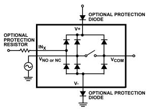
FIGURE 8. OVERVOLTAGE PROTECTION
