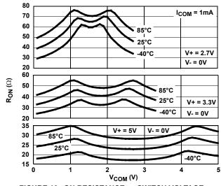
FIGURE 10. ON RESISTANCE vs SWITCH VOLTAGE
